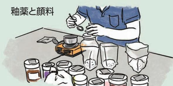
釉薬はタイルを焼く前に塗るガラス質の膜で、色・色ムラ・ツヤ・光沢を表現する。釉薬の原料は、タイルと同じ長石や珪石、粘土に石灰質を加えた基礎釉。これを焼成することで、化学反応により色彩が劇的に変化する。一方の着色剤・顔料は、設定された色が出るように酸化金属と補助剤を混ぜ、一度焼成したもの。いずれもタイルならではの色彩の素となる。
