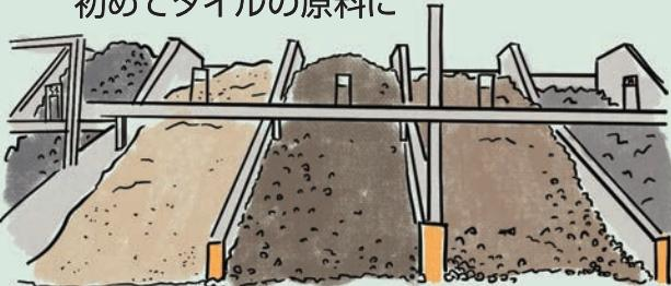
精製された長石や珪石、粘土と水を練り合わせ、初めてタイルの原料「坯土」となる。最も一般的な坯土の配合は、長石や珪石が約70%、粘土が約30%。タイル原料には乾式製法と湿式製法があり、乾式製法にはスプレードライヤーという機械で乾燥させて粉末状にした坯土を、湿式製法には原料を練り、含水率20～25%に調整した土の塊を出荷する。
