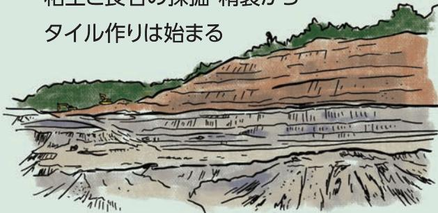
岐阜県東濃地方(東美濃地域)は、日本でも有数の良質な粘土鉱物を含む土壤。山から採掘される長石や珪石、粘土といった原石がタイルの原料となる。タイルの表面に使われる釉薬も、長石やコバルトなどの鉱石から作られてる。長石や珪石は不純物が含まれているため、水選別や脱鉄を行って精製され、粘土は木くずやゴミ、泥水などを取り除く処理を重ねて出荷される。
